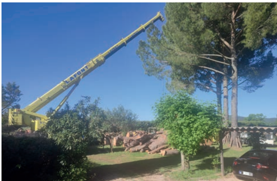
Grue mobile télescopique, utilisée pour l'abattage des grands arbres
